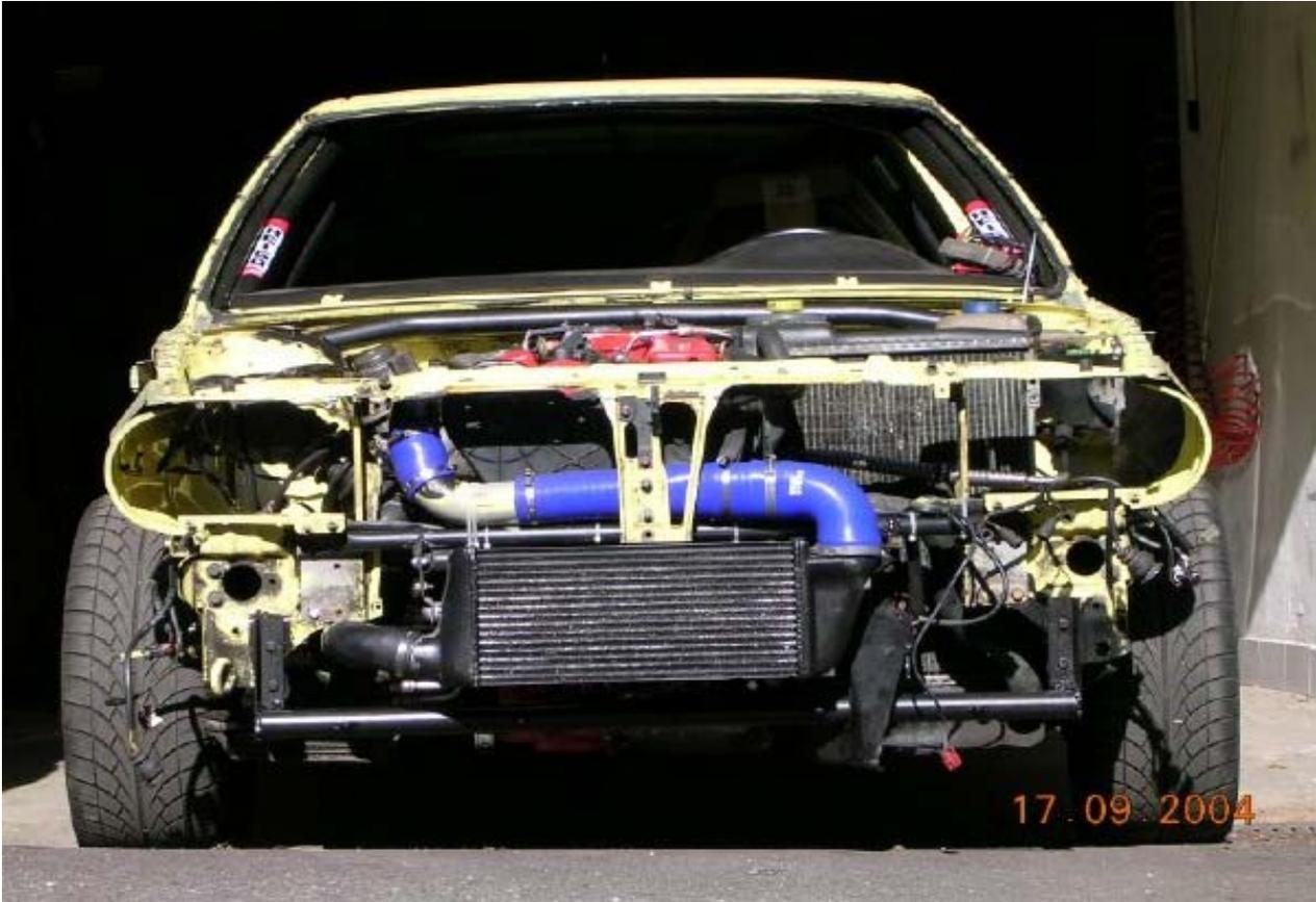
Zukünftig werden wir noch viel Detailarbeit benötigen um Kilo für Kilo abzuspecken. Wenn man bedenkt dass eine Türe 30kg hat, sieht man dass noch Potential da ist. Die Heiz und Lüftungsanlage sowie die meisten Kabelbäume wurden entfernt. Das Auto wiegt jetzt 1330 kg.
