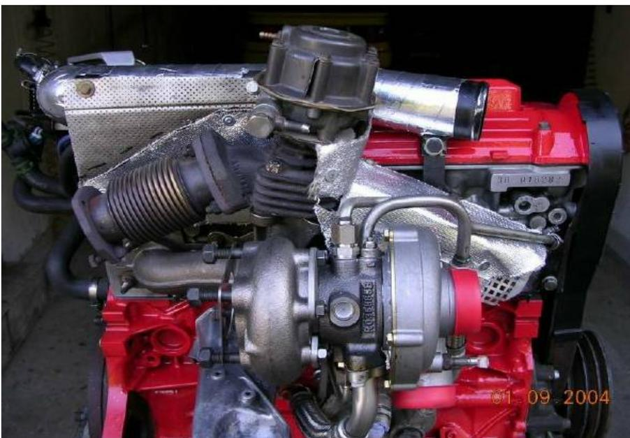
Die Leistung des so getune'ten Motors schätzen wir auf 280 PS mit, und auf 320 PS ohne Restriktor. Der nutzbare Drehzahlbereich erstreckt sich von 3300 bis 6000 U/min.
