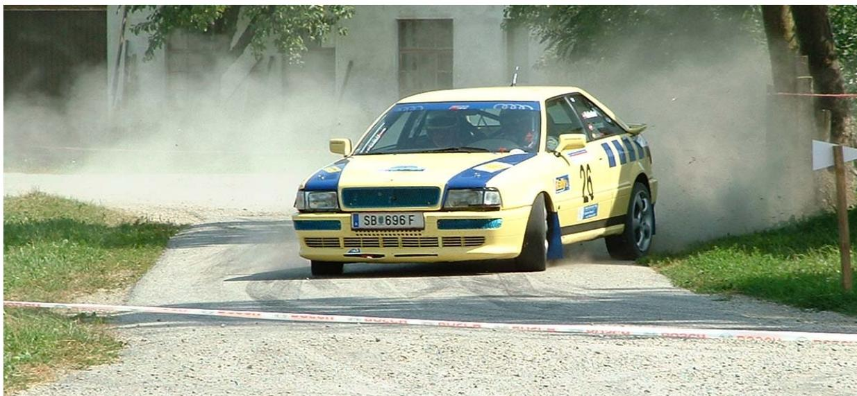
Ab jetzt mit neuem Design und Turbo-Porsche Bremsanlage auf der Vorderachse sowie A200-20VT auf der HA.
